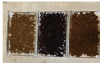
Gambar 5.10 Hasil pengovenan batang, pelepah, TKKS sawit setelah pretreatment basa
