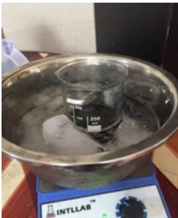
Gambar 2.9 Proses stirring dalam ice bath
