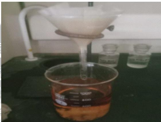
Gambar 2.15 Proses isolasi selulosa dari TKKS
