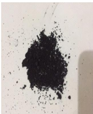
Gambar 2.12 Serbuk Graphene Oxide setelah furnace
