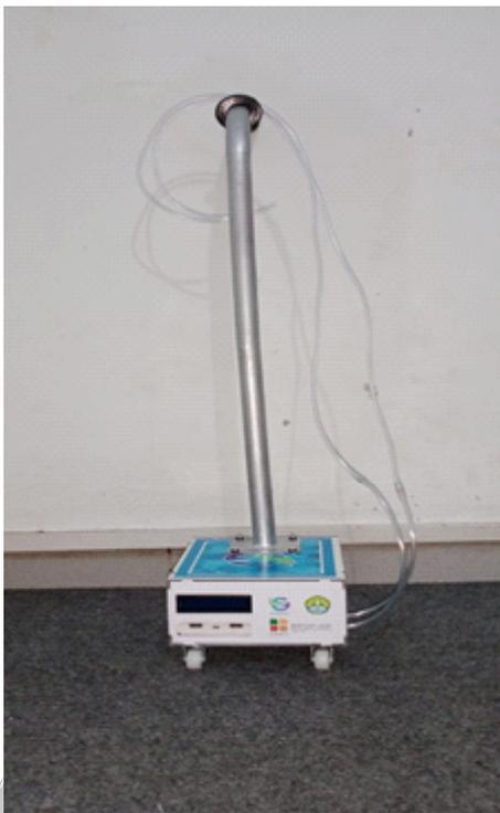
Gambar 3.13 Prototipe *electronic nose* di Lapangan
