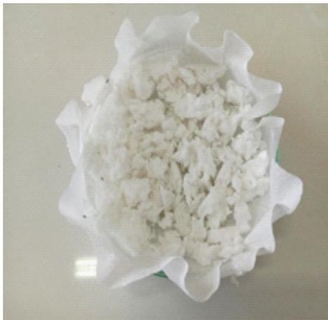
Gambar 2.17 Hasil sintesis NaCMC
