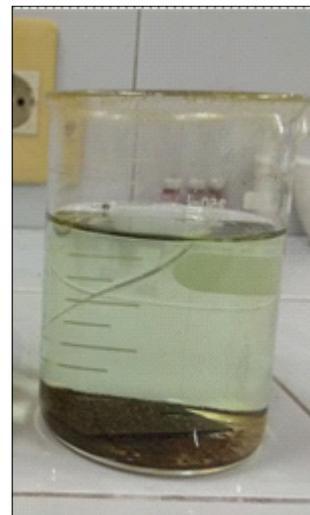
Gambar 4.16 Perendaman Baja ASTM A36 dengan inhibitor
