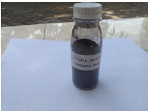
Gambar 4.3 Toner Printer Laser dari Cangkang Sawit
