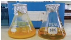
Gambar 5.4 Proses saponifikasi ekstrak buah kelapa sawit
