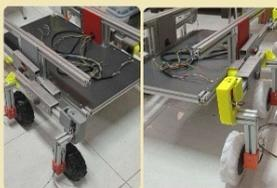
Rangka robot dan sistem rocker bogie dirancang menggunakan profil aluminium yang kuat namun ringan, dipilih karena kemampuannya mendistribusikan beban dengan baik dan kemudahan dalam perakitan. Untuk mendukung pergerakan di medan yang tidak rata, seperti perkebunan sawit, digunakan brushless DC motor ber-torsi tinggi, serta roda besar yang sesuai dengan sistem rocker bogie, memastikan robot dapat bermanuver dengan stabil di berbagai jenis medan.
