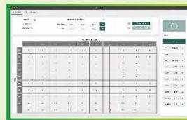
Aplikasi Desktop: Berfungsi melakukan mapping volume gas CPG yang dimasukkan ke dalam mesin DDF berdasarkan variasi nilai RPM dan TPS
