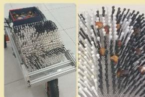
Penelitian ini juga mencakup perancangan robot roller yang dilengkapi dengan mekanisme roller untuk mengumpulkan brondolan sawit saat bergerak melewati area perkebunan. Roller tersebut dirancang untuk menggelinding di atas tanah dan secara otomatis mengangkat brondolan yang ditemuinya ke dalam kontainer robot.
