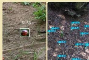
Sistem AI di Jetson Orin Nano dirancang untuk mendeteksi dan mengestimasi jarak brondolan sawit. Kamera digunakan untuk mengambil gambar yang menjadi input bagi algoritma computer vision dan deep learning. Gambar ini diproses untuk mendeteksi keberadaan dan mengestimasi jarak brondolan sawit. Depth camera digunakan untuk membantu mengukur jarak brondolan secara akurat berdasarkan data visual yang diperoleh.
