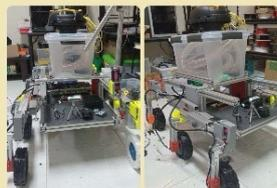
Sistem kendali robot menggunakan mikrokontroler seperti Arduino atau Jetson Orin sebagai pusat pengendali utama yang mengatur motor, sensor, dan robot arm. Brushless DC motor yang menggerakkan roda dikendalikan oleh driver motor, sementara servo torsi tinggi untuk robot arm dioperasikan melalui sinyal PWM untuk gerakan presisi. Kendali manual dilakukan menggunakan radio remote control, yang memungkinkan kontrol penuh atas pergerakan robot, robot arm, dan sistem vacuum.
