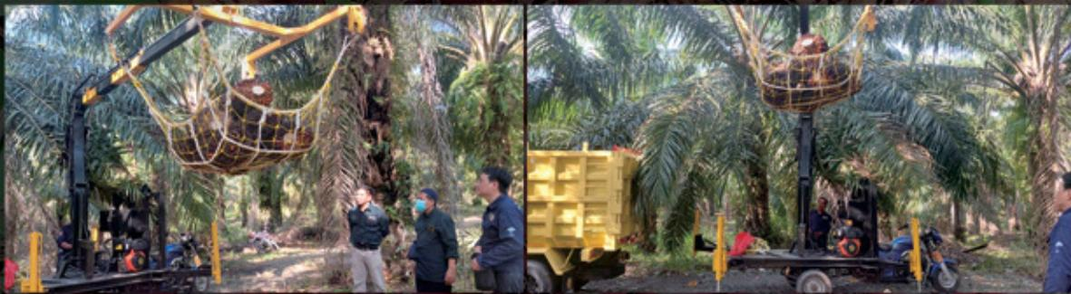
**Tujuan Khusus** dari penelitian ini adalah menciptakan sebuah alat angkat yang mampu berpindah secara cepat (*mobile*), memudahkan memuat / *loading* sawit dari tempat penampungan ke atas truck dan ergonomis untuk tenaga kerja angkat sawit.
