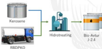
Skema Uji Co-Processing RBDPKO untuk Bio-Avtur
