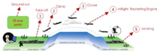
Uji terbang dilakukan pada ketinggian 10.000 ft dan 16.000 ft. *In-flight Restarting Engine* dengan menggunakan J2.4 telah dilakukan pada ketinggian 10.000 ft untuk mengetahui reaksi *engine* saat dihidupkan pada kondisi udara yang tipis
