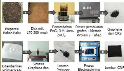
Diagram proses Pengolahan Cangkang Kelapa Sawit (CKS) menggunakan metode pirolisis dan Produksi Carbon Nanofiber (CNF) menggunakan metode electrospinning.
