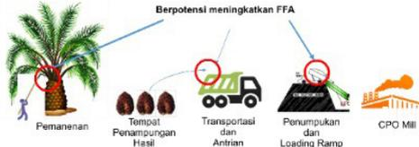
Peningkatan kadar FFA pada produk CPO berpotensi disepanjang rantai penanganan buah sawit sejak pemanenan hingga proses produksi minyak kelapa sawit
