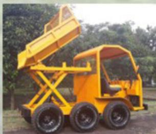
Mekanisme scissor lift untuk Truck Bin
