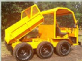
Mekanisme hidrolik unloading
