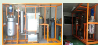
Gambar 7. Reaktor Hidrolisis dan Reaktor Perperlakuan untuk Produksi Furfural
