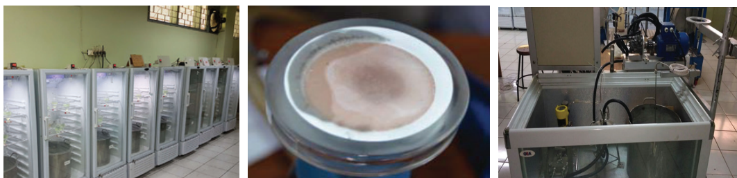
Gambar 2. Pengujian BXX pada rig test penyumbatan filter
