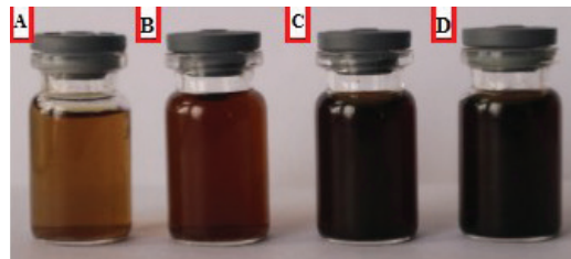
Gambar 4. Produk cair hidrolisis TKKS: Run 14 – asam levulinat (A); Run 4 – asam levulinat campuran (B); Run 5 – furfural (C); dan Run 10 – furfural campuran
