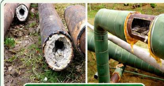
Kerak Material Anorganik pada Pipa
