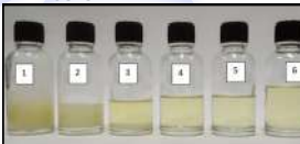
Gb. 5 Biodiesel yang diproduksi dengan metoda non katalitik SMV dan aplikasi nozzle fine bubble setiap interval 30 menit proses reaksi
