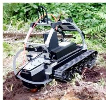
Robot iFovib_G versi II (p x l x t) 680 x 445 x 205 mm.
